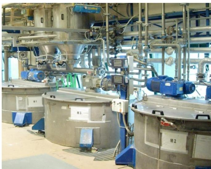
Figura 3.3.C. Miscelatori per la realizzazione delle produzioni a caldo
